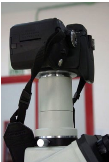
Adaptación de cámara dsr1 Canon, anilla, adaptador Motic
